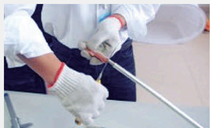
7 根据端子的插入深度,确定云母绝缘剥除长度
