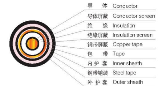
3.6/6kV~26/35kV单芯交联聚乙烯绝缘钢丝铠装电力电缆
