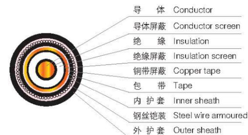
3.6/6kV~26/35kV三芯交联聚乙烯绝缘电力电缆
